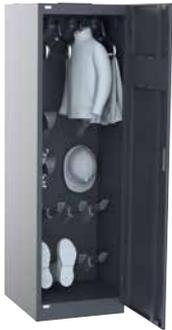
Schrank aus sendzimirverzinktem, pulverbeschichtetem Stahlblech, je 8 Trocknungsarme aus Aluminium mit speziellen Kunststoff-Trocknungsdüsen für Schuhe (4 Paar) und Handschuhe (4 Paar), 4 herausnehmbare Ausblas-Kleiderbügel aus Edelstahl (Air Hanger) für das Aufhängen von Jacken und Hosen, sowie 4 innenbelüftete Helmhalterungen.
